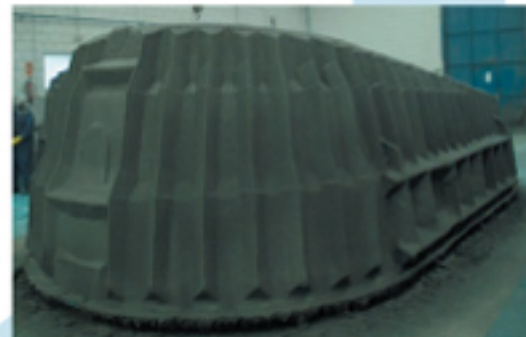
Terminación con refuerzos de poliéster y espumado con aislante DUROMOL®
