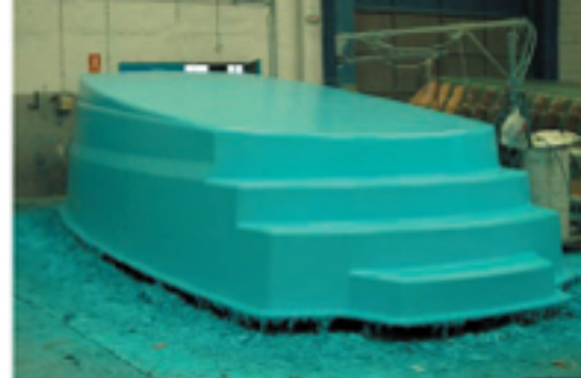
Molde pintado con gel-coat de neopentil-glicol
